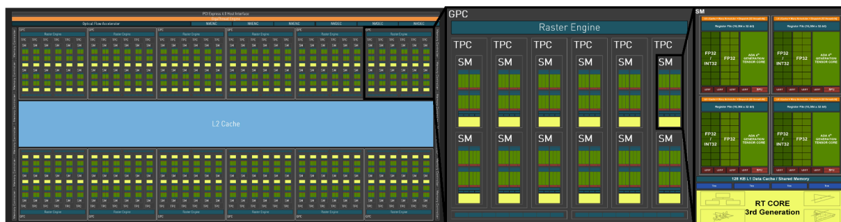
Figure 2.2 – Schéma de l'architecture matérielle ADA des cartes graphiques NVIDIA [NVI23]. Les cœurs du GPU (SM) sont principalement composés d'unités de calcul et permettent de les répartir à leurs threads respectifs.
